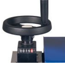
Posibilidades de ajuste exactas para todos los tableros entre 10 y 45 mm
