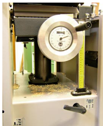
Die im Höheneinstellrad integrierte Messuhr macht das Justieren der Holzdicke sehr viel übersichtlicher als der Blick auf eine lineare Skala. Optional ist die Uhr auch als Digitalvariante zu bekommen.
