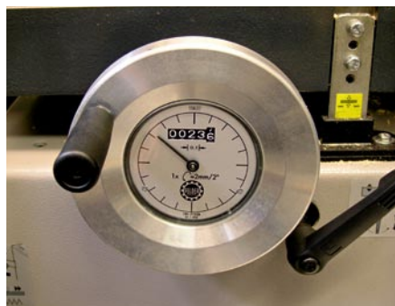
Mehr als vier Millimeter Spanabnahme lässt die Maschine nicht zu und stoppt zuverlässig ein keilförmiges Bohlenstück (kleines Bild).
