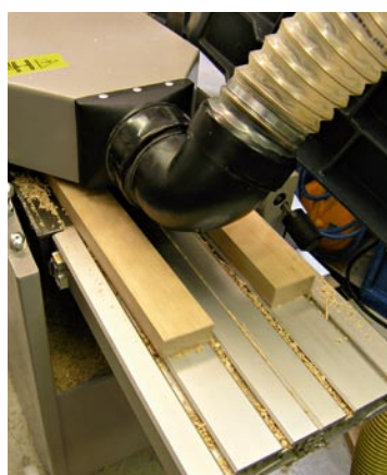
Der Paralleltest: Zwei gleichzeitig ausgehobelte Leisten unterscheiden sich danach nur um höchstens einen Zehntelmillimeter voneinander.
