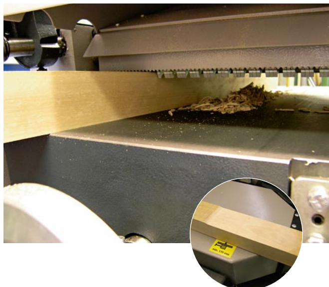
Mehr als vier Millimeter Spanabnahme lässt die Maschine nicht zu und stoppt zuverlässig ein keilförmiges Bohlenstück (kleines Bild).
