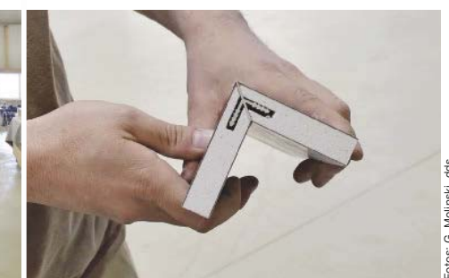
... und klebt die Feder samt gerundeter Stoßbocke mit PUR-Montagekleber ein
