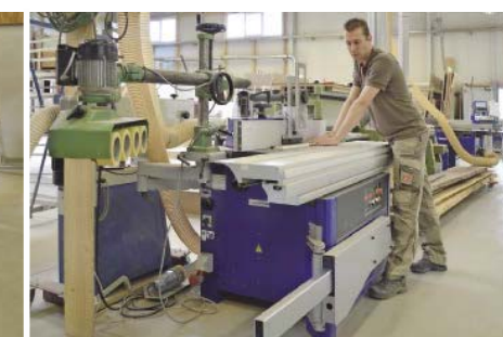
... fräst an der Tischfräse eine Nut für die im Schiffsausbau beliebte Winkelfeder ein ...
