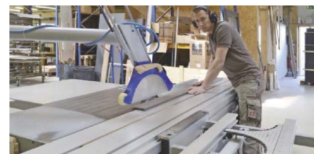
Robert Drews schneidet mit der Formatkreissäge eine 45°-Schräge, ...
