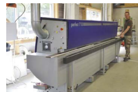
... bekantet die CPL-beschichtete Gipsfaserplatte mit PUR-Kleber, ...
