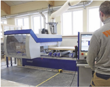
/ Flexibel mit fünf Achsen: Das CNC-Bearbeitungszentrum H50 von Format-4 ist vielseitig einsetzbar.
