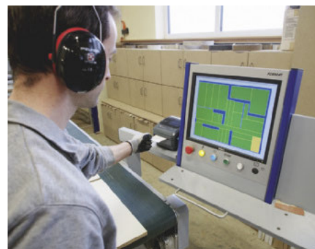
„Der Bildschirm zeigt dem Bediener eindeutig, auf welches Teil das gerade gedruckte Etikett gehört.“
