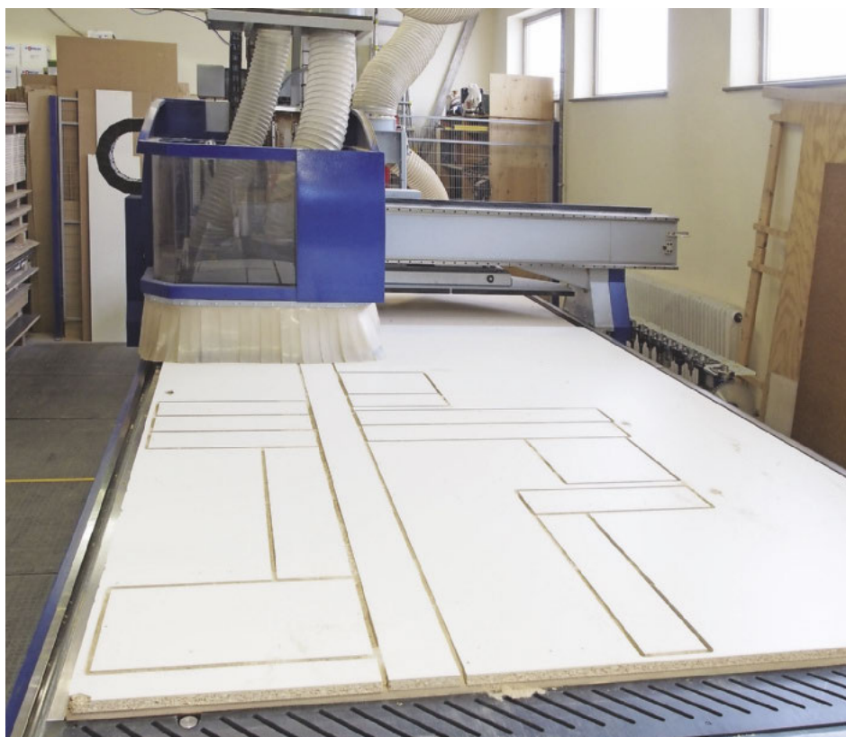
„Die Nestingmaschine ist vom ersten Tag an absolut problemlos gelaufen“, freuen sich Josef und Frank Wagner. Die Maschine läuft mindestens drei Tage pro Woche voll durch und der Verschnitt liegt bei maximal 10 %.
