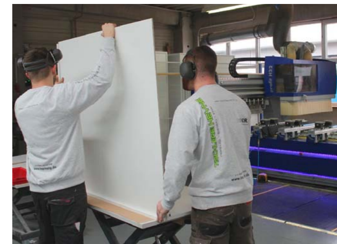
Just in time und ohne Umwege: Korpusse werden direkt nach der Komplettbearbeitung montiert.
