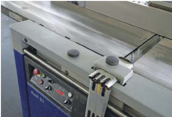
/ Herzstück der Werkstatt: Die Felder-Abricht-Dickenhobel-Kombi mit Silent-Power-Hobelwelle sorgt für erstklassige Oberflächen.
