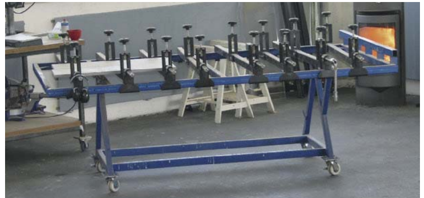
/ In Eigenregie gefertigt – robust und wartungsarm: Der liegende Verleimständer mit massiven, variabel positionierbaren Niederhaltern bringt satte Kräfte auf – ganz ohne Druckzylinder.
