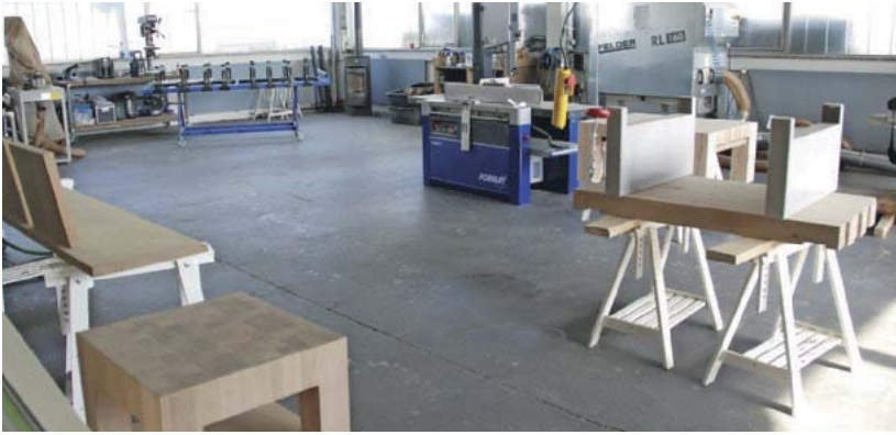
/ Übersichtlich, aber effektiv im Felder-Dreiklang: Der Werkstattbereich für Holz besteht aus zwei Stationärrmaschinen mit Absauganlage: einer Abricht-Dickenhobel-Kombi und einer Kreissäge.
