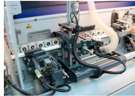
/ Die Tempora zeigt sich in grundsolidem Maschinenbau und mit hochwertiger Aggregatetechnik. Hier ist das Eckenrundungsaggregat zu sehen.
