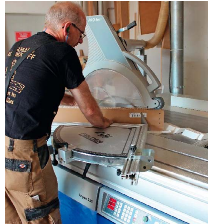
/ Gehrungsschnitte an tiefen Türzargen werden auf der Formatkreissäge erledigt: Tischlermeister Norbert Koch reizt dazu die Kappa 550 von Format-4 voll aus.
