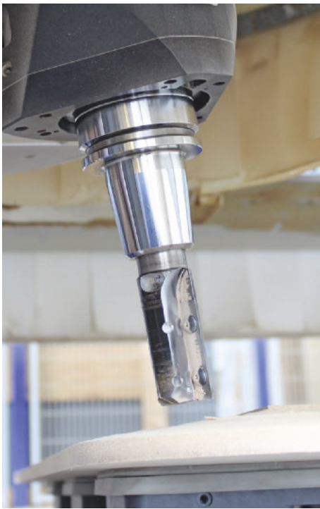
/ Freiheit in fünf Achsen: Die kardanisch gelagerte, wassergekühlte Hauptspindel kommt in jeden Winkel.
