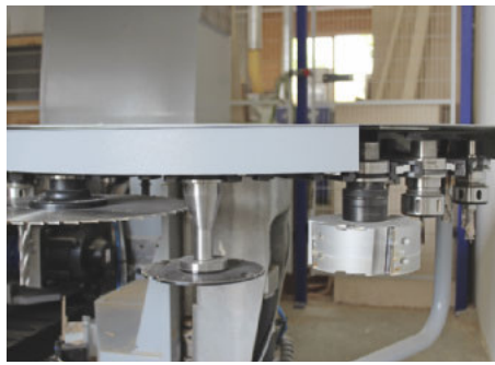
/ Völlig ausreichend: Der mitfahrende Tellerwechsler und ein stationärer Pick-up bieten Platz für 34 Werkzeuge.
