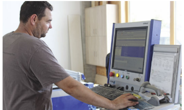
/ Schneller Abruf an der Maschine: In der Programmiersoftware von Format-4 hat Hans Thumann zahlreiche Teile parametrisch abgelegt.
