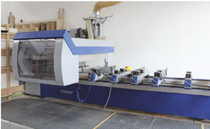
/ Mit praxisbezogener Komplettausstattung auf vergleichsweise kompaktem Raum: Das 5-Achs-CNC-Bearbeitungszentrum Profit H50 von Format-4.
