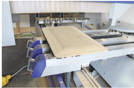
/ Ehemals ein riesiger manueller Aufwand: Komplettbearbeitung einer profilierten MDF-Front.
