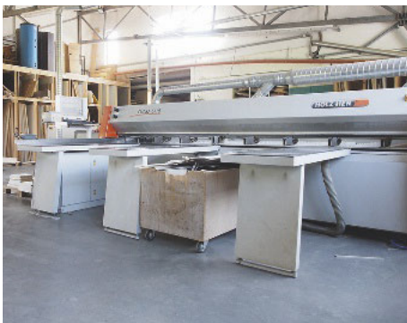
/ Der Plattenzuschnitt erfolgt auf einer Druckbalkensäge von Holz-Her. Die Zuschnittoptimierung...
