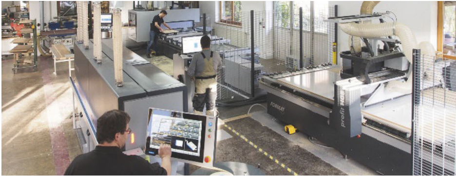
/ Blick in die gut organisierte Werkstatt: Rechts die Nestingmaschine Profit H08, dahinter das 5-Achs-Bearbeitungszentrum Profit H350. Im Vordergrund die Kantenanleimmaschine vom Typ Tempora F800. Kurze Wege und ein durchgängiger Datenfluss sorgen in der Schreinerei für eine hohe Produktivität.
