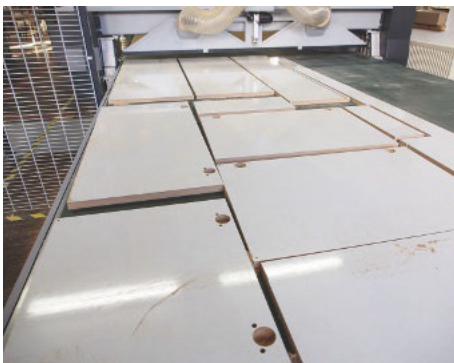
/ Im Anschluss an die Bearbeitung wird das Nest automatisch über ein Transportband aus der Maschine herausgefahren. Danach ...
