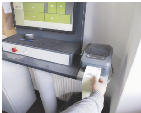
/ ... erfolgt der Etikettendruck. Dabei zeigt der Bildschirm dem Bediener eindeutig grafisch an, für welches Teil das aktuell gedruckte Etikett vorgesehen ist.
