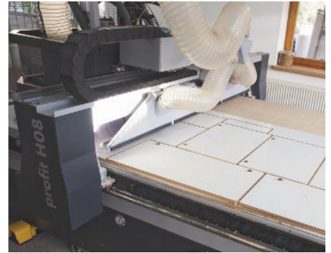
/ Nesting-CNC bei der Arbeit: Die Profit H08 formatiert die Teile und führt alle Fräs- und Bohrbearbeitungen in der Fläche durch.
