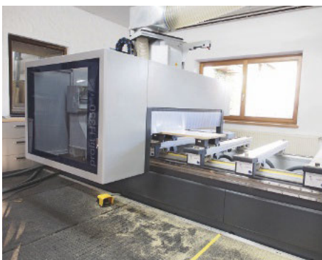
/ Bietet reichlich Flexibilität: Das 5-Achs-CNC-Bearbeitungszentrum Profit H350 bewährt sich als Multitalent für unterschiedlichste Bearbeitungen.
