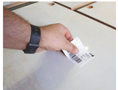
/ Die Etiketten enthalten sämtliche für die Weiterbearbeitung erforderlichen Informationen. So werden sie an der CNC für den Programmstart eingeschannt.
