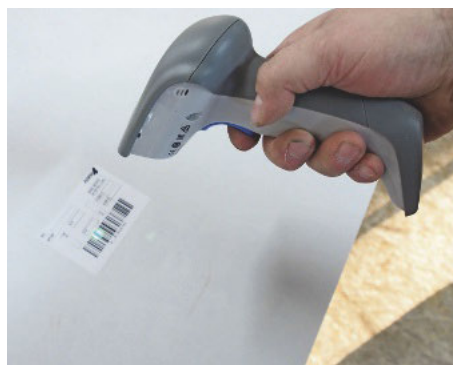
/ Der Aufruf der lauffähigen CNC-Programme am Bearbeitungszentrum erfolgt einfach, indem das Teiletikett gescannt wird.
