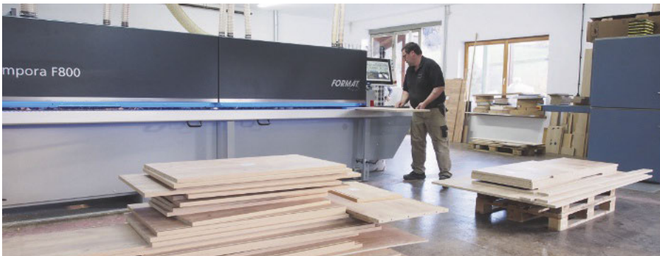
/ Die Kantenbearbeitung erfolgt an einer Format-4 Tempora F800. Sämtliche Maschinen- bzw. Bearbeitungsfunktionen lassen sich vom großen Touchscreen aus hochpräzise steuern, ohne dass die Maschinenhaube geöffnet werden muss.
