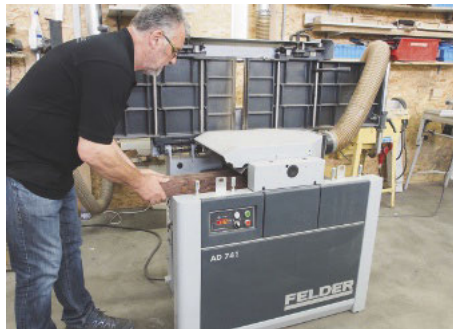
/ Die pfiffigen Bogenbauer setzen auf kompakte und dennoch präzise sowie robuste Maschinen der Felder-Gruppe. Hier: Kombiniertes Abricht- und Dickenhobel.
