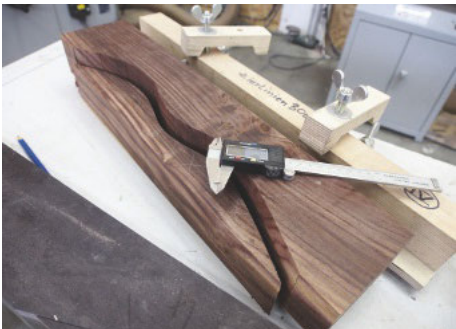
/ Aufgetrenntes Griffstück. Bei der Herstellung ist in allen Phasen sehr hohe Präzision gefordert, denn die Teile sind später hohen Beanspruchungen ausgesetzt.
