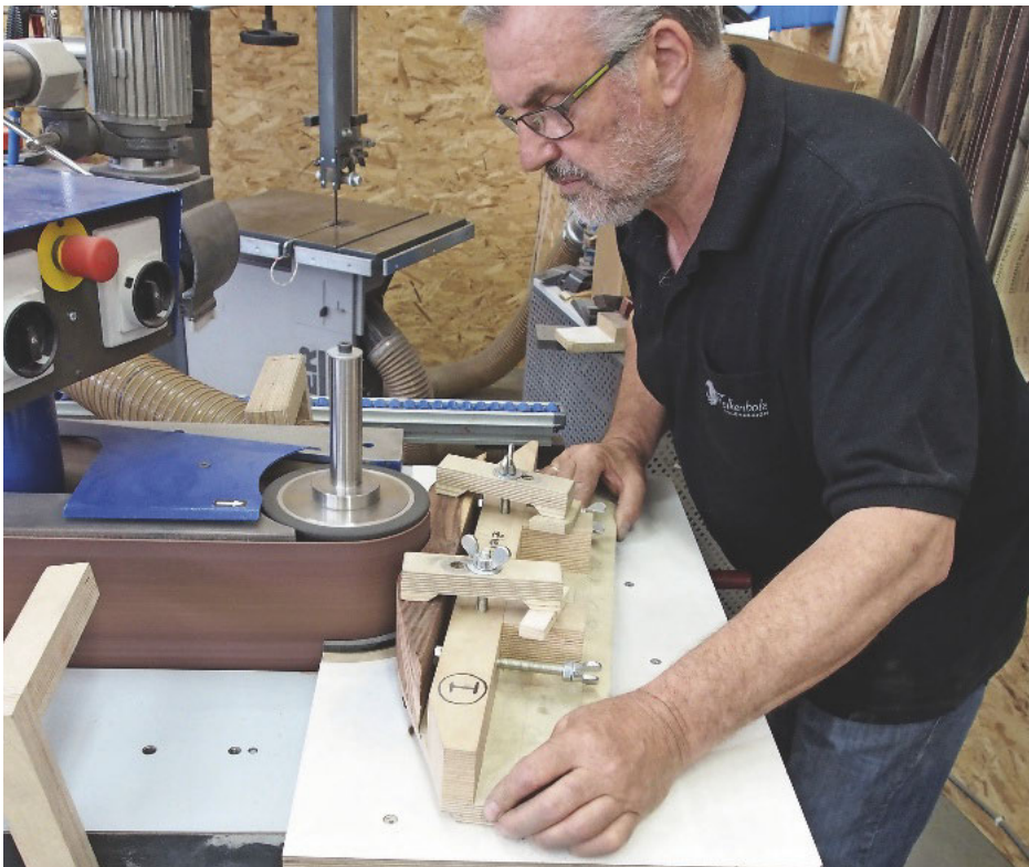
/ Hier wird auf Maß geschliffen: An der Felder-Kantenschleifmaschine bekommen die zuvor ausgeschweiften Griffteile ihre finale Kontur. Dazu werden sie auf Schablonen gespannt und am Anlauftring entlanggeführt. Die Bearbeitung muss sehr genau sein, denn im Anschluss wird der Griff samt Furnieradern verleimt.
