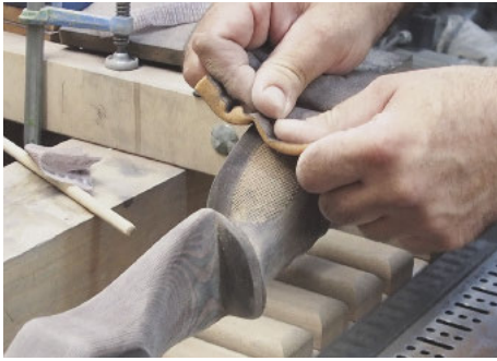
/ Bei der Bearbeitung auf den Mini-CNCs werden sogar die feinen Riffelungen eingefräst. Für den letzten perfekten Schliff ist natürlich Handarbeit angesagt.
