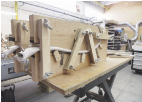
/ Auch die Herstellung der Wurfarme ist komplex. Fiberglas, Carbon, Furniere und allerlei andere Materialien werden dabei höchst präzise verklebt und bearbeitet.
