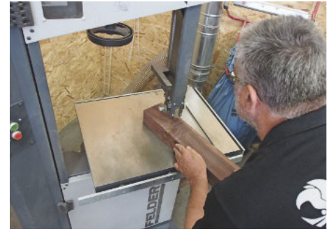
/ Hier wird ein Massivholz-Griffrohling zunächst mit der Bandsäge aufgetrennt, weil dort später Furnieradern zwischengeleimt werden.
