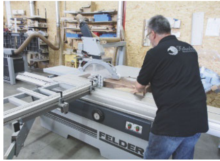
/ Zuschnitt eines Griffrohlings auf der Formatkreissäge. Bis auf die finale Formbearbeitung an zwei kleinen CNCs sind Standardmaschinen angesagt.
