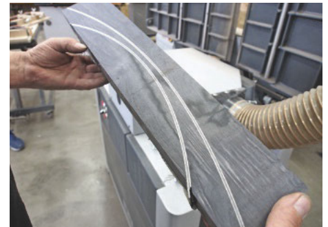
/ Jeder Griff ein echtes Unikat: Nach dem präzisen Zwischenleimen der Furnieradern läuft die Maserung des Ausgangsrohlings wieder perfekt durch. Cool!
