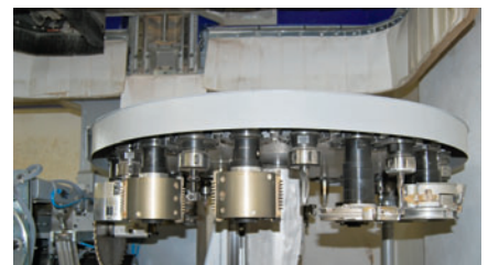
50 Werkzeugplätze in drei Magazinen reduzieren den manuellen Werkzeugtausch auf ein Minimum
