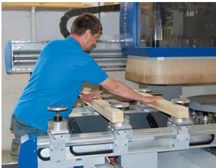
Nachdem sich Spanner automatisch positioniert haben, spannt Jürgen Prasse die Kanteln auf
