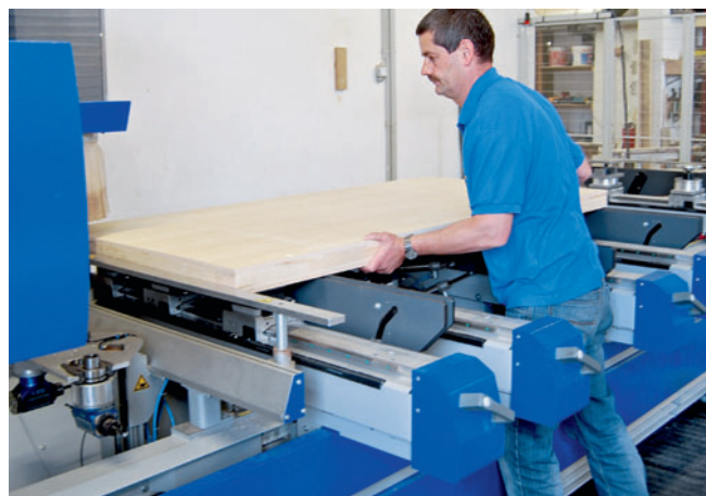
Jürgen Prasse schiebt einen Haustürblattröhring in Position. Das BAZ wird alle Arbeiten in einer Aufspannung erledigen
