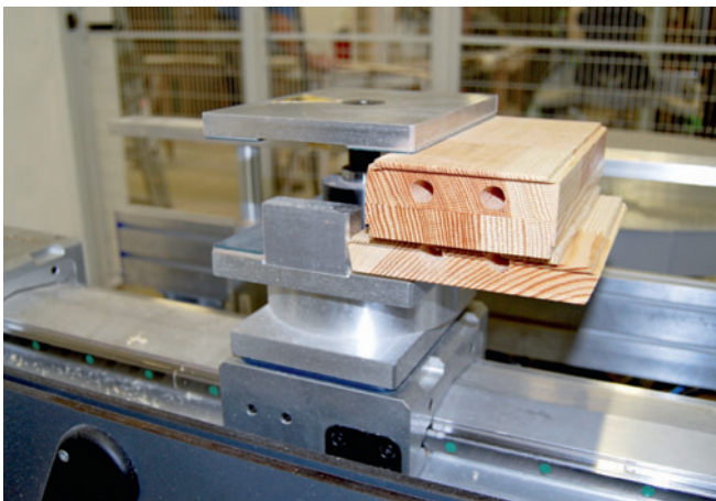
Alles sicher im Griff: Dieser Spezialspanner eignet sich für besonders kurze Teile mit nur 150 Millimetern Länge
