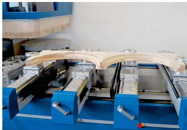
Ein wahrer Alleskönner: Neben rechtwinkligen Fenstern fertigt Jürgen Prasse auf der CNC auch Sonderformen wie dieses Doppelbogenfenster
