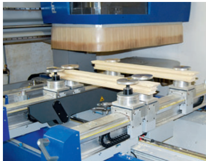
Das vordere Greiferpaar übernimmt den ersten Fries zum Fräsen der vierten Seite
