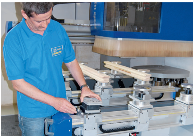
Das Umstellen von den Spannzangen für Rahmenteile auf Sauger für flächige Werkstücke erfolgt in wenigen Handgriffen
