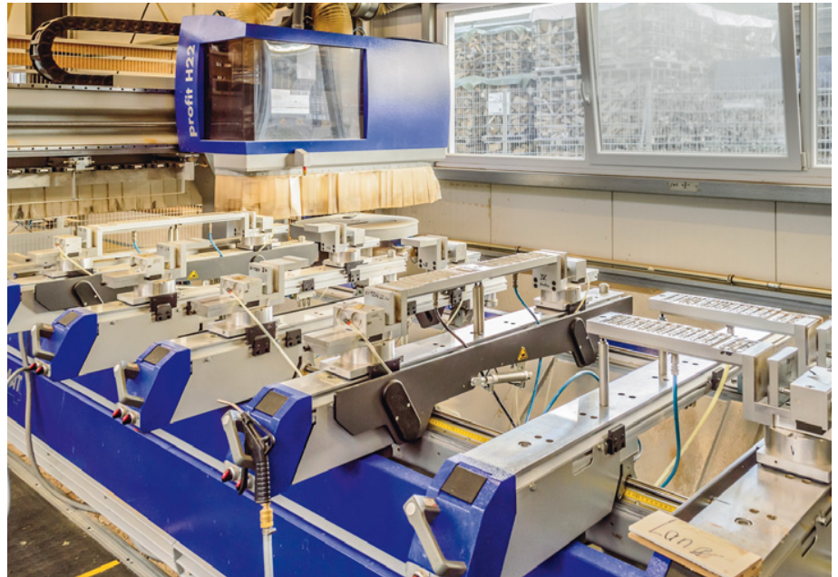
Format-4 hat die eigens für Teuto entwickelte pneumatische Spannvorrichtung in der Ausbildungswerkstatt in Hall in Tirol hergestellt
