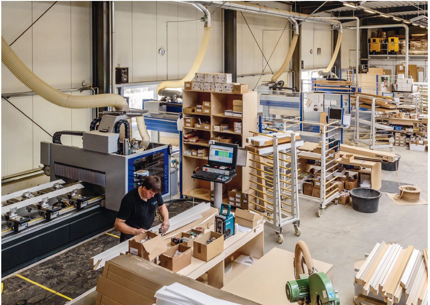
Links in einer Reihe stehen vier CNCs. Die Maschinenführer schaffen das Material herbei und wieder fort, montieren und verpacken
