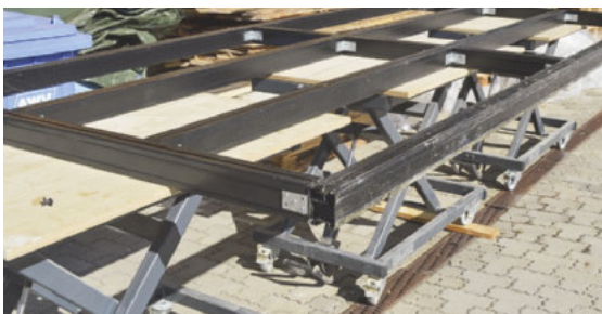
Flexibel: Aus drei kleinen Hubtischen wird bei Bedarf ein großer Arbeitstisch
