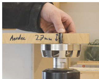
... in die Cruing-Turbine. Sie bläst die Späne zur Absaugung
