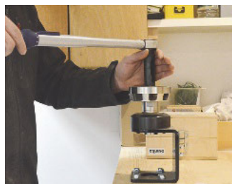
Einspannen des Schafffräsers zum Auftrennen der Platten ...
