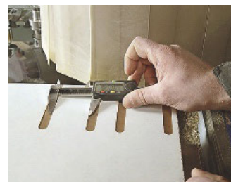
Messen des Fräserdurchmessers für die Werkzeugdatenbank
