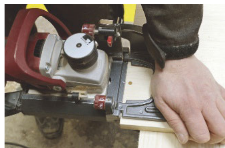
Die Verschlussbohrung des Verbinders zeigt, wo das Gegenstück einzufräsen ist
