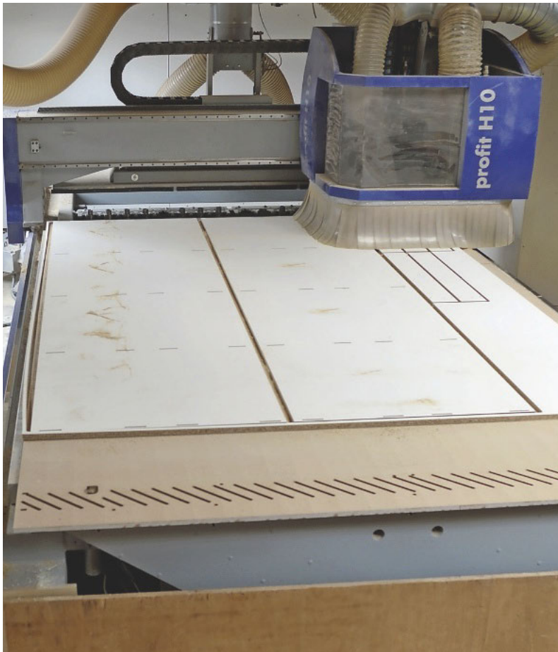
Etwa 20 Minuten braucht die CNC, um eine Platte zuzuschneiden und Beschläge und Verbinder einzufräsen
