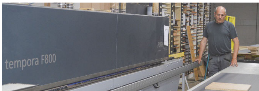
Engpass beseitigt: die 2017 angeschaffte Kantenanleimmaschine ist mit einer automatischen Rückführung ausgestattet.
