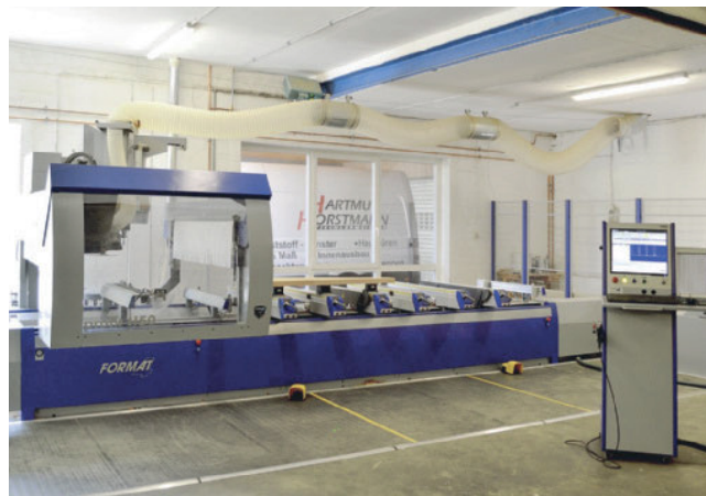
Die 5-Achs-CNC Profit H50 von Format-4 bringt Effizienz in die AV und die Produktion
