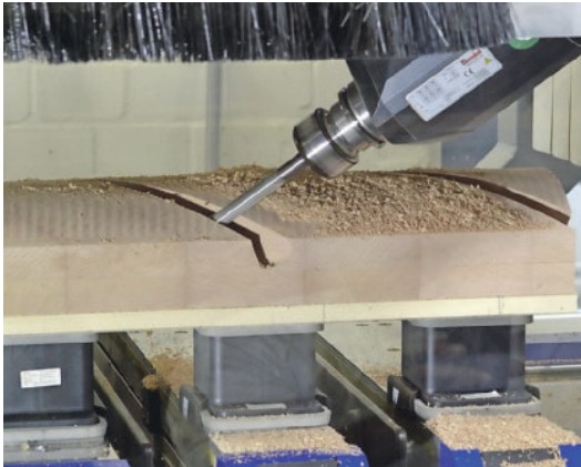
Die Profit H50 im interpolierenden 5-Achs-Betrieb. Für dieses Foto ist die Absaughaube oben geblieben
