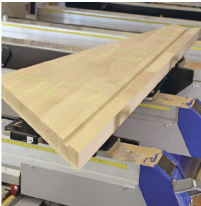
Ein Laserprojektor zeigt die Positionen der Sauger und Werkstücke
