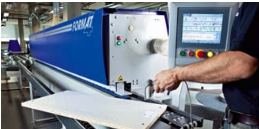
Die Steuerung der Kantenleimmaschine liest die Platten- und Kantendicke ein
