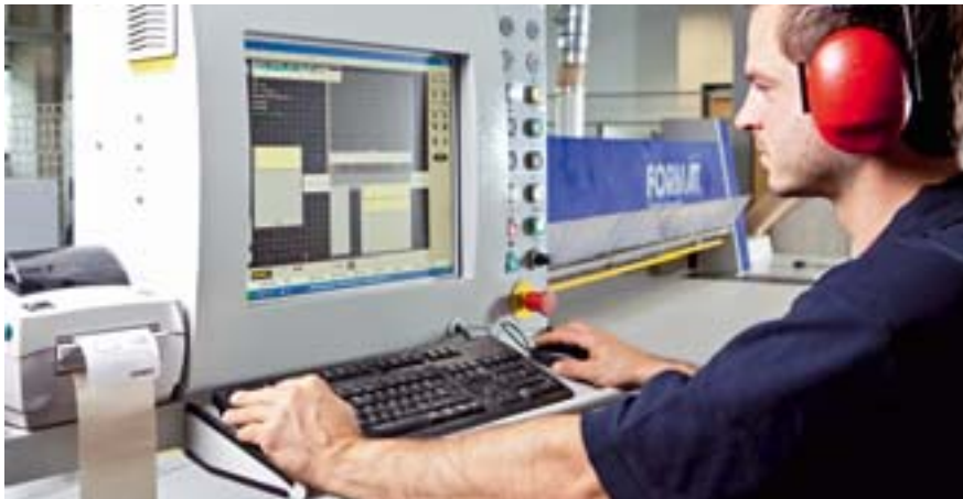
Ardis-Software optimiert den Zuschnitt und schreibt alle wichtigen Informationen auf Barcodeetiketten
