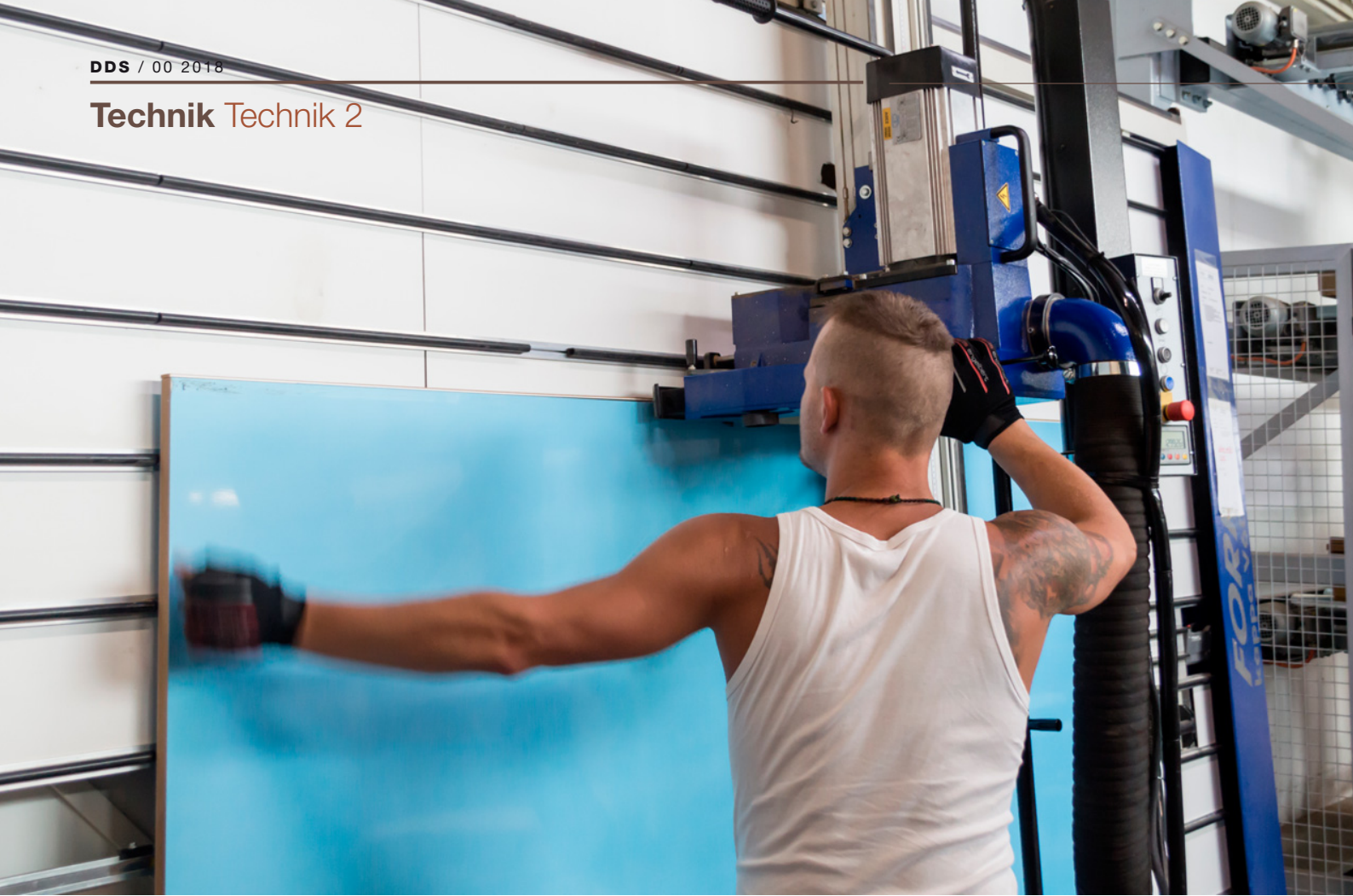
Für den Besäumschnitt schiebt Michael Mühlberger die Brücke mit dem Sägeaggregat nach rechts
