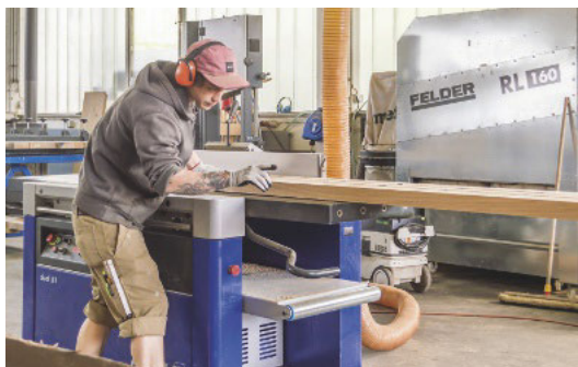
Johannes Müller nutzt die Maschine als Abrichte; erst für die Fläche, später zum Fügen
