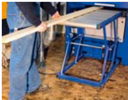
10 Angenehm: die Tischverlängerung an der Auslaufseite
