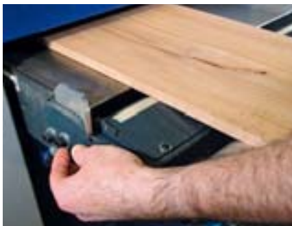
9 Hilfreich: der Gleitmittelauftrag an der Einlauf-seite
