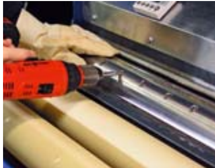
7 Noch schneller: das Lösen der Keilleisten-schrauben mit dem Akkuschauber
