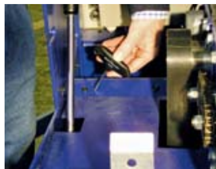
5 Aufgeräumt: das Werkzeug zum Messerwechsel ist sinnvoll untergebracht
