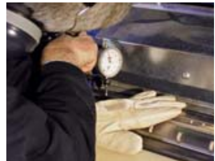
4 Null Toleranz: Rundlaufprüfung des Schneidflugkreises
