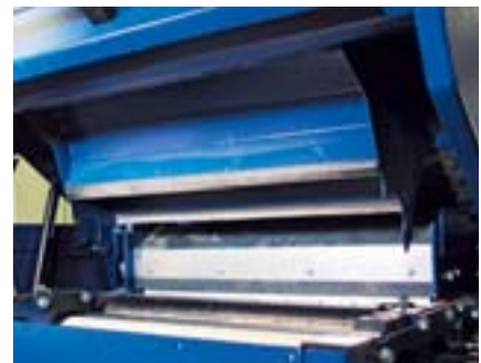
11 Genial: mit Gummilippen wird der Hobel-bereich verschlossen.
