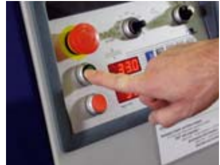
8 Übersichtlich: das Bedienfeld mit dem Notaus-Schalter
